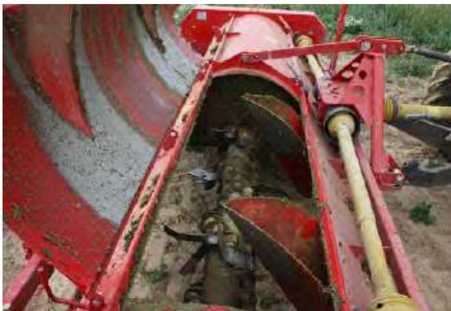
Photo 1 : Déflecteurs sur broyeur Grimme (source : Arvalis)
