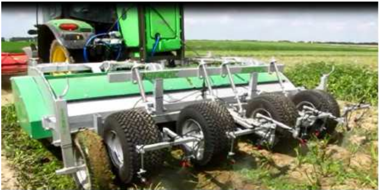
Photo 3 : Combinaison broyage + plombage des buttes + pulvérisation complémentaire chez Agronomic (source : Arvalis).
