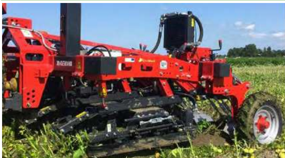
Photo 5 : tireuse de fanes à bande chez Rema (source : Arvalis)
