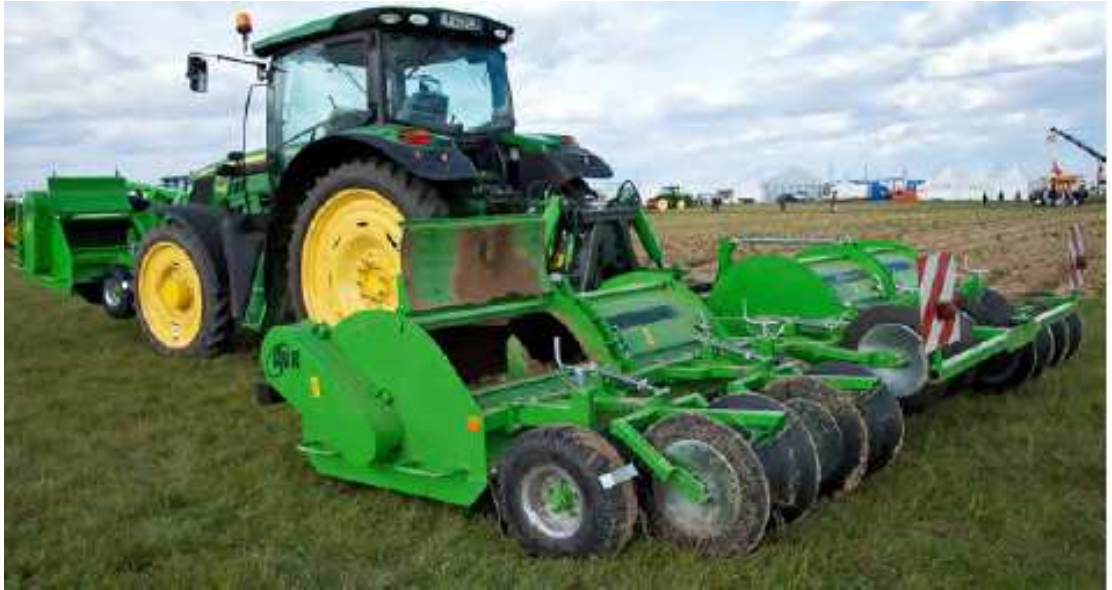
Photo 2 : broyeur AVR à 3 éléments avec roulage des buttes (source : Arvalis)
