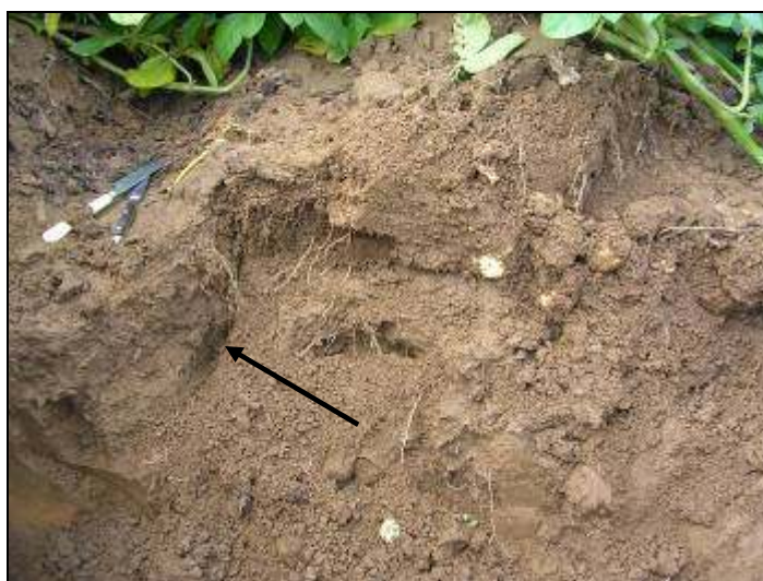
Observation de la macroporosité et des zones de compaction à l'aide d'un couteau selon sa résistance à la pénétration (gauche) et mise en évidence de « chemins préférentiels » empruntés par l'eau
