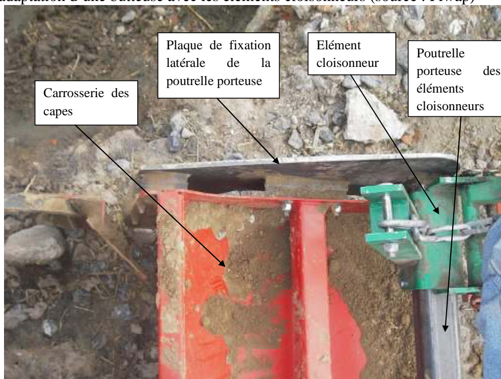
Photo 2 : adaptation d'une butteuse avec les éléments cloisonneurs (source : Fiwap)
