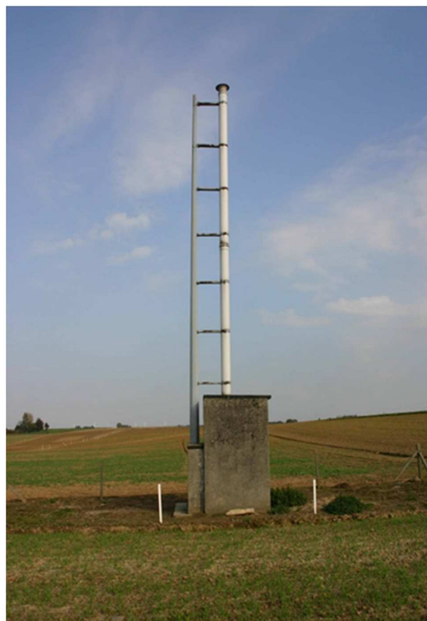
Figure 3 : Piège à aspiration de type «Rothamstead».
