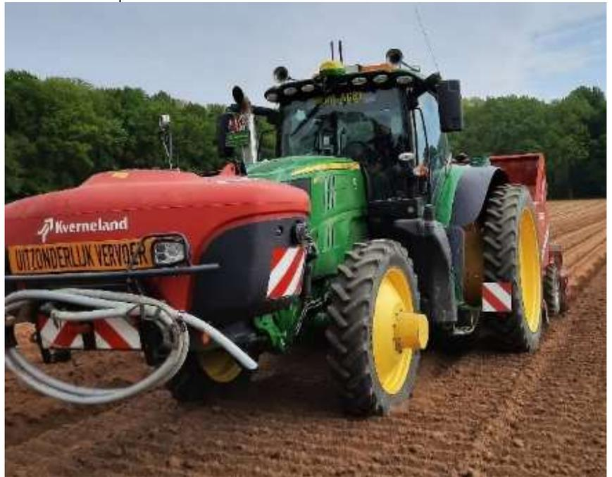
l'engrais liquide est injecté le long de deux socs passant sous le plant ( $\pm$  3-4 cm sous les tubercules espacés de 20 cm).
