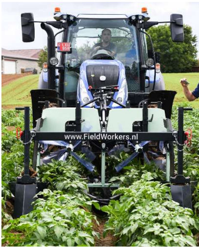
Figure 3 : Balai à doryphores de la firme Fieldworkers (NL) en démonstration sur l'essai à Gembloux
