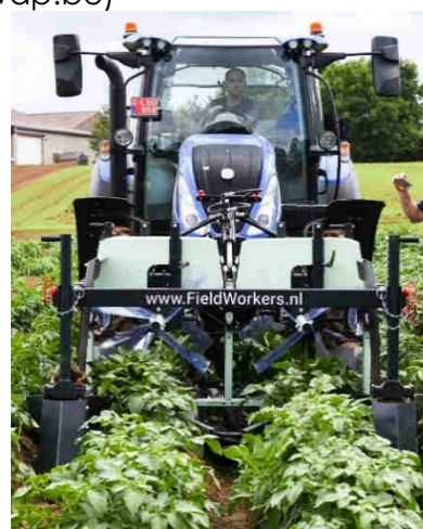
Figure 1 : Balai à doryphores de la firme Fieldworkers (NL) en démonstration sur l'essai à Gembloux
