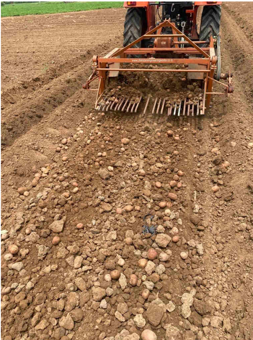
Photo 3 : Soulevage de pommes de terre dans une terre avec des cailloux (crédit photo : JS/Advait Agrotech)
